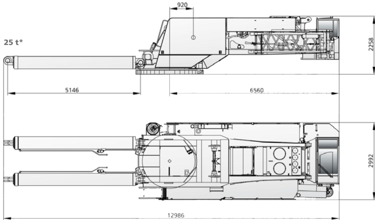
\* incl. luffing cylinder · inkl. Wippzylinder · avec vérin de relevage · incl. cilindro di impennatura · incl. cilindro de elevación ·
